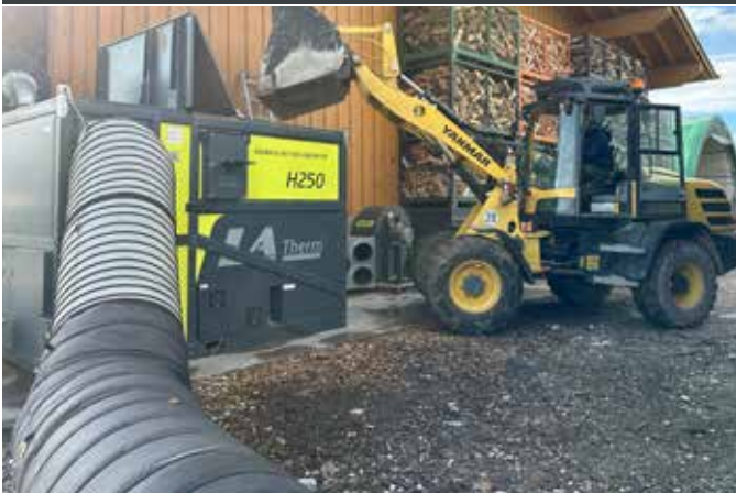
Einfache Beschickung einer H250 mit Radlader. Der H250 ist direkt an zwei Trocknungscontainer angeschlossen.
