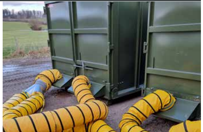
Wärmeverteilung leicht gemacht. Über Warmluftschläuche gelangt die Trocknungsluft mühelos in den Trocknungscontainer.
