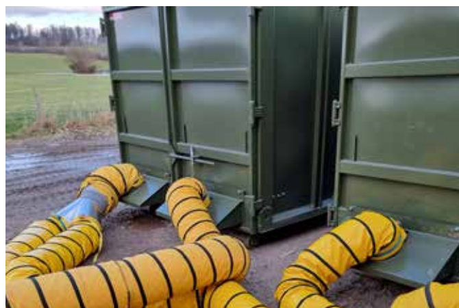
Répartition de la chaleur simplifiée. Grâce aux tuyaux d'air chaud, l'air de séchage est acheminé sans effort vers le conteneur de séchage.
